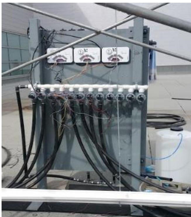
Figure 18 : Système d'injection de la solution nutritive
